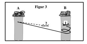
Figur 3: Der Pilot Nr. 2 sieht, wie Nr. 1 einkreist und sofort steigt. Nr. 1 wird bereits auf der Höhe von Nr. 2 sein, bevor Nr. 2 den Aufwind erreicht hat.
