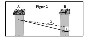
Figur 1: Zwei gleiche Flugzeuge fliegen vom Cumulus A zum Cumulus B zur selben Zeit in gleicher Höhe ab; das Steigen war 2 m/s und man erwartet 2 m/s unter dem Cumulus B. Pilot Nr. 1 stellt den Mac Cready-Wert 2 ein; Pilot Nr. 2 den Wert 0 (bester Gleitwinkel).
