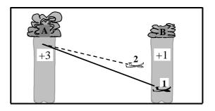
Zwei gleiche Flugzeuge fliegen gleichzeitig mit gleicher Höhe aus 3 m/s Steigen unter dem Cumulus A ab zum Cumulus B. Der Pilot Nr. 1 erwartet dort wiederum ein Steigen von 3 m/s und stellt deshalb den Mac Cready-Wert 3 m/s ein. Pilot Nr. 2 ist skeptisch und stellt den Wert 1 m/s ein. Der Aufwind unter dem Cumulus B bringt beiden Piloten nur 1 m/s Steigen.
