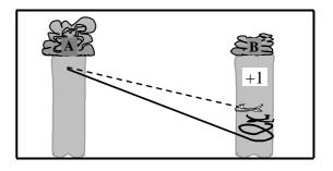
Pilot Nr.1 mit dem Einstellwert 3 m/s erreicht den Aufwind bei B schneller. Trotz seines Vorsprungs kann er aber nur wenig Höhe gutmachen, weil er nur 1 m/s findet. Wenn Pilot Nr. 2 mit seinem Einstellwert 1 m/s den Aufwind bei B erreicht, ist er deutlich höher als Nr. 1, der, wie sich jetzt herausstellt, zu schnell geflogen ist.
