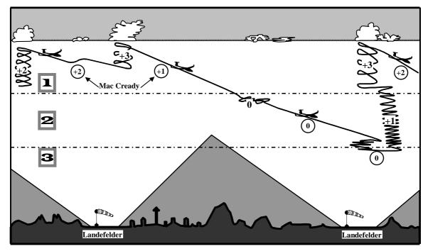
In der obersten Schicht kann die maximale Reisegeschwindigkeit erreicht werden. Starkes Steigen wird erwartet. Nur die stärksten Aufwinde werden genutzt. Angesichts einer schwierigen Querung wird der Wert 1 m/s eingestellt als Kompromiss zwischen der maximalen Reisegeschwindigkeit und der besten Gleitzahl.
